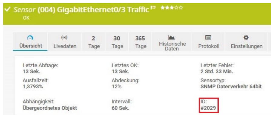
Abbildung 14. Sensor-ID im PRTG Network Monitor nachschauen
